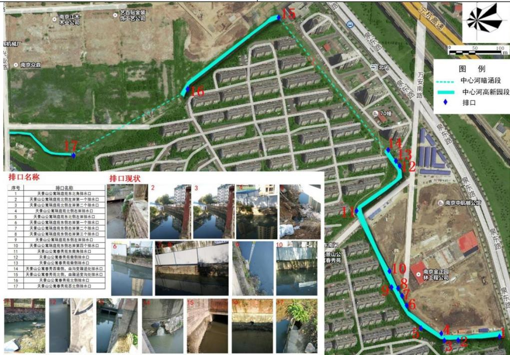
中心河（高新园段）河道沿线设有雨污混流排口情况
