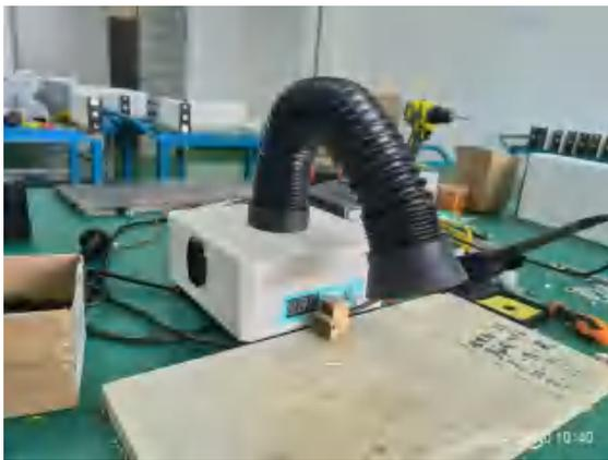
移动式焊接烟尘净化器
